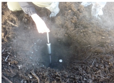
En måling af NH 3 -emission i et "hul" i en bunke isoleret kompost viste > 20ppm ved 60 °C.
