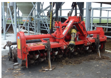
Fræser til bearbejdning af komposteringsmåtten. Denne maskine kan skovle komposten rund.
