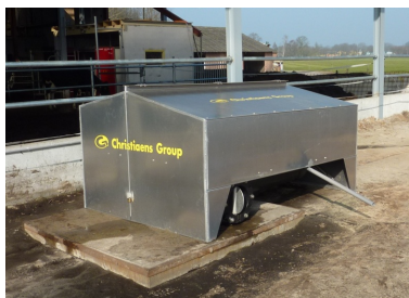
Teknikkasse med blæser og ventilsystem til udsugning og indblæsning. Rørene, som de er, indstøbt i bunden af komposteringsmåtten.
