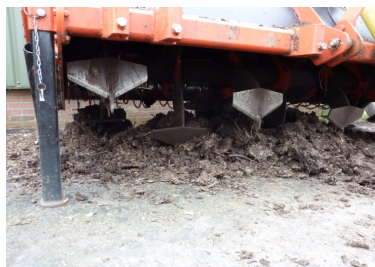
Fræser til bearbejdning af komposteringsmåtten. Denne maskine kan skovle komposten rund.
